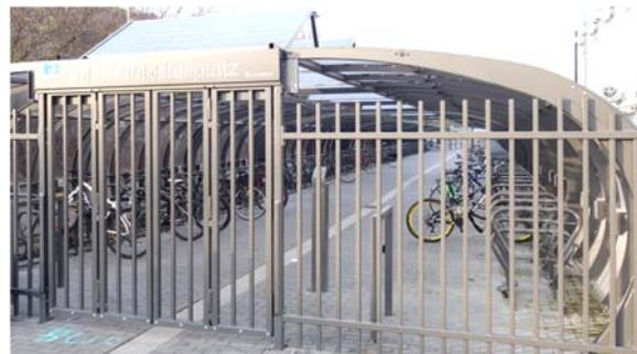
Abbildung 50 – Sammelschließanlage. Foto: VAR+
